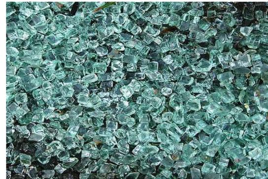
El **vidrio templado** se fabrica a partir de una hoja de vidrio común ya cortada a medida, con sus bordes pulidos y con todas las perforaciones o entrantes necesarios para su colocación, que luego recibe un tratamiento térmico que mejora sus resistencia mecánica y térmica entre 4 y 5 veces, siendo **mucho más resistente a los golpes y al choque térmico que el vidrio común**. Este tipo de vidrio tiene como particularidad que al romperse pierde integridad y se destroza en pequeños fragmentos
