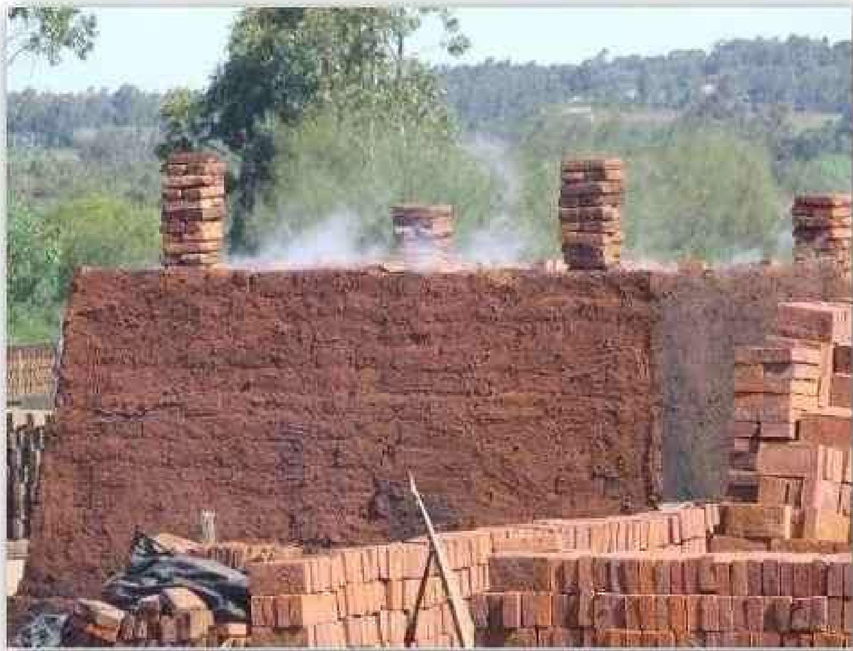
Horno de campaña: cocción ladrillos comunes en proceso de desarmado del horno (50000 a 100000 ladrillos)
